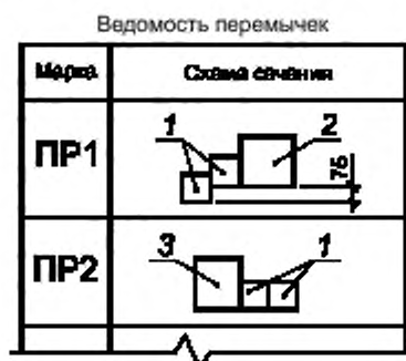
Рисунок В.1 — Пример выполнения ведомости перемычек
