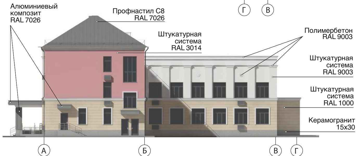
Фасад в осях А-Г
