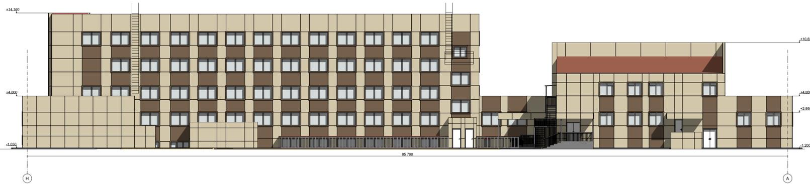
Фасад в осях 1-7 (колористика) М 1:200
